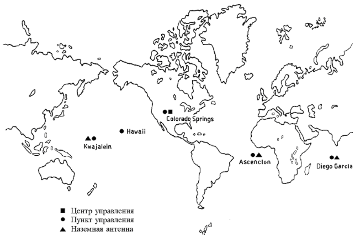
Рис. 5. Подсистема управления GPS.
